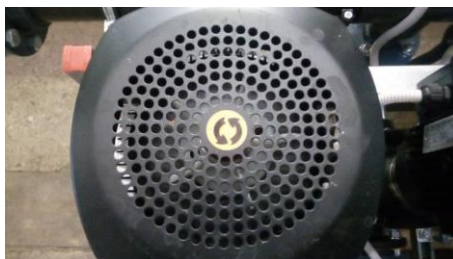
Фотография 2. Стрелка направления вращения на кожухе вентилятора.
