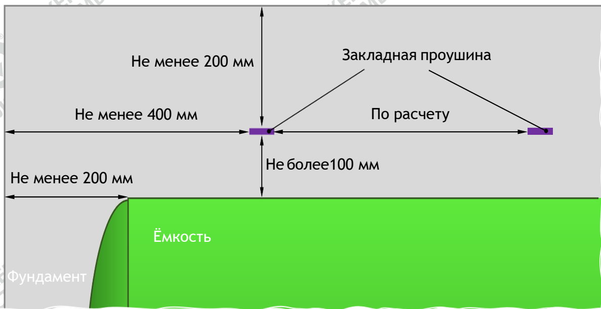
Рис. 12. Закладка проушин на фундаментной плите (вид сверху)
